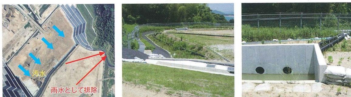
図 3.1 雨水排除計画例（その 1）
