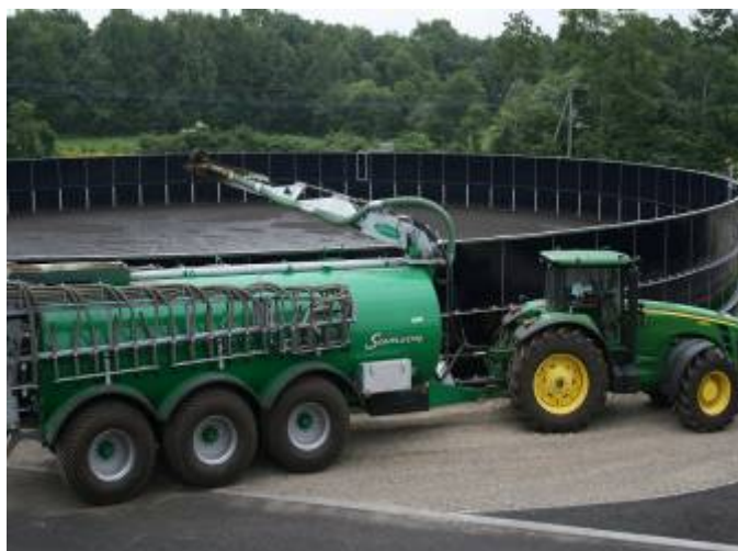
消化液散布機
